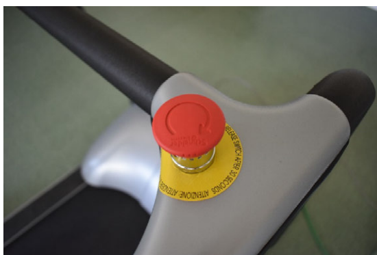
Botón de emergencia desactivado (en su posición más alta). Debe encontrarse en dicha posición para que el tapiz funcione
